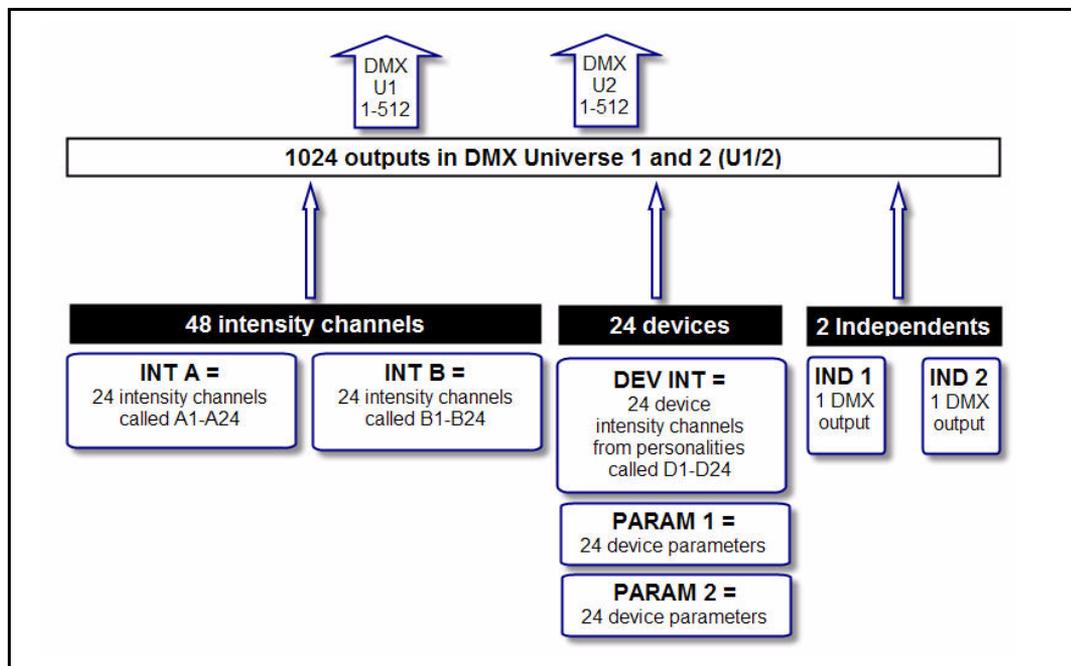
Un projecteur motorisé (device) peut avoir jusqu'à 48 paramètres (attributs) différents, chaque paramètre nécessitant l'une ou plusieurs des 1024 sorties. Ceci dépend du type de projecteur, un modèle (template) adapté permet de configurer tout cela de façon automatique.
