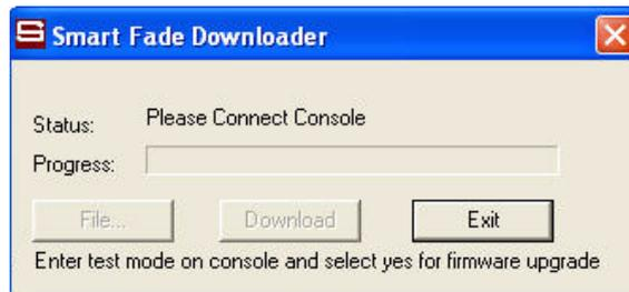
Etape 4: Démarrez la console en mode mise à jour de logiciel. Pour cela, maintenez les touches **SOLO** et **UNDO** enfoncée pendant plus de 6 secondes pendant le démarrage.
