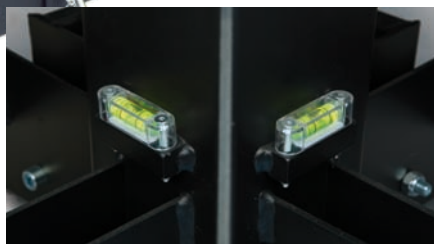
2 niveaux à bulle pour mise à l'aplomb
