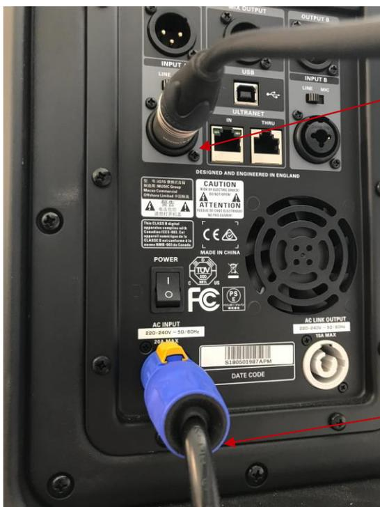
Brancher votre câble de modulation en XLR sur ce schéma (référence PRMC dans catalogue) dans le connecteur combo.
